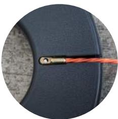
Inserte la puntera de la cinta pasa cable en la ranura transversal del carrete.
